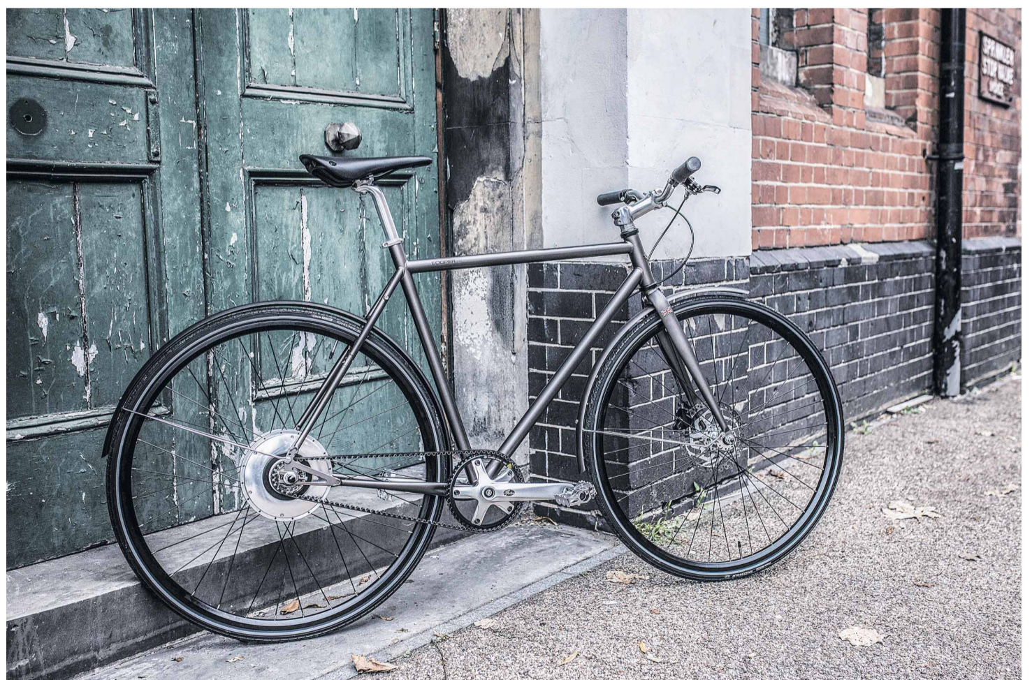
In der Praxis wird, wie hier beim Cooper E Disc, der Nabenmotor inkl. Rekuperation meist am Hinterrad verbaut.
