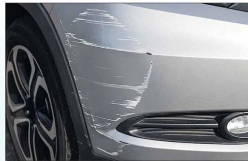
Sieht harmlos aus, kann aber unangenehme Folgen haben: Wenn die Befestigungen des Stoßfängers angebrochen oder innenliegende Bauteile beschädigt sind, gefährdet das unter Umständen die Fahrsicherheit. Laien können das kaum feststellen – deswegen sollte immer eine Werkstatt aufgesucht werden. tzn-Foto: thamkc200100027/123rf/Itzehoer Versicherungen
